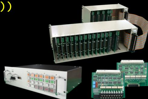
制御ボード(FPGA、最大99ボード拡張(1ボード:16点))は一例ですがお客様の仕様に合わせてボードの設計・製造として、マイクロコンピュータによる制御は勿論のこと、EIA232、422、485、I2C、SPI、Ethernet、非同期バス(133MHz程度)、WishboneBus、AvalonBus等各種インターフェースへの対応や、光ファイバーを用いた高速通信にも対応可能です。
