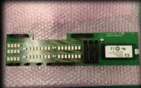
PLCとステッピングモーター間に設置され、不具合時にはハードワイヤ信号にて電磁ブレーキON及び制御系からのパルス遮断により駆動部を停止させ機器の破損を防止します。またノイズや放射線下でも使用できるよう鉄やFPGA等を使用しない設計となっております。
